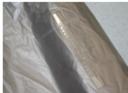
NB: Il transponder sarà di tipo passivo per la rilevazione attraverso radiofrequenza, denominato transponder TAG UHF (860-915 MHz) class 1 Gen2 ISO 18000-6c.
